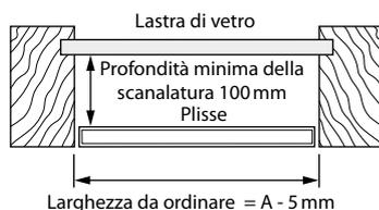
⚠ Per accertare eventuali scostamenti, prendere la misura B (larghezza) sempre in più zone/punti. Utilizzare sempre il valore misurato di larghezza minimo. Per la lunghezza (dimensione H) tener conto del foro d'aerazione in alto e in basso e della larghezza del profilo di montaggio.
