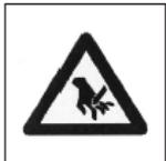
EVITARE IL RISCHIO DI INTRAPPOLAMENTO (INDUMENTI LARGHI) IN PROSSIMITA' DEI RULLI. NEL PUNTO DI PASSAGGIO DELL'ASTA TELESCOPICA ALL'INTERNO DEI RULLI ESISTE IL RISCHIO DI MOVIMENTO INASPETTATO. QUESTO POTREBBE CAUSARE L'INTRAPPOLAMENTO O LO SCHIACCIAMENTO.
